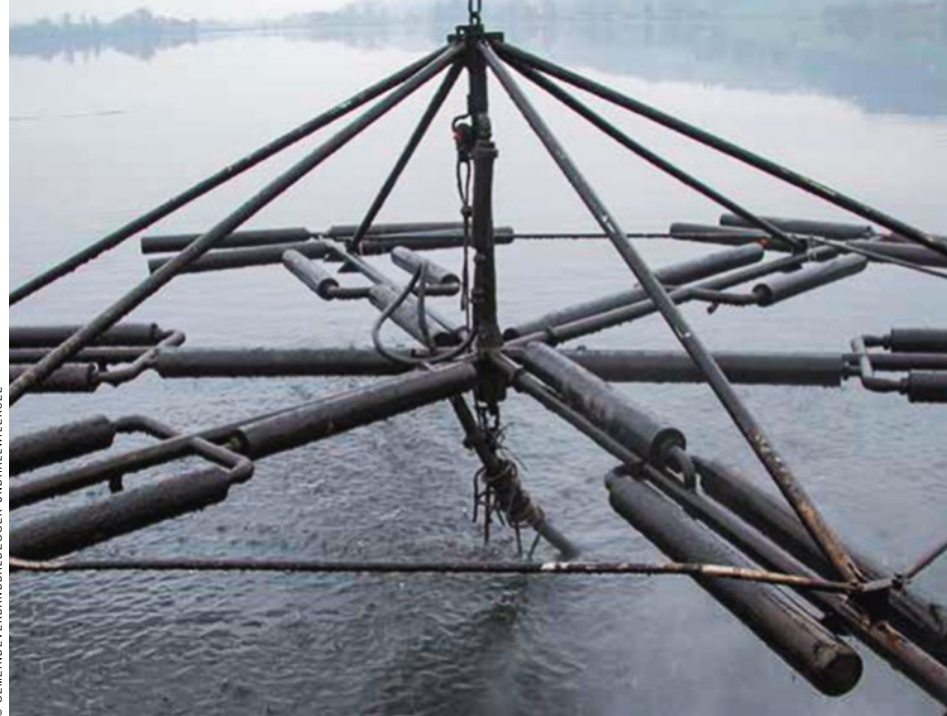
Diffusor zur Belüftung eines Sees mit Sauerstoff oder zur Versorgung mit Druckluft für die Zirkulation (dasselbe Gerät, zwei Funktionen).
